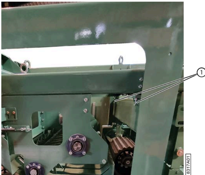
Fig. 26: Régler la distance au broyeur à cailloux
